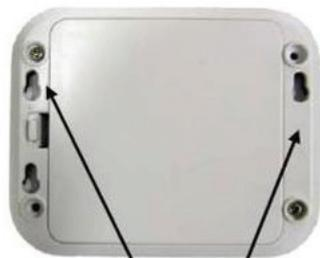
Positioneer de gaatjes over de schroeven en schuif het basisstation naar beneden voor een goede bevestiging
